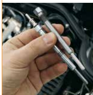
De BERU-ruimer - (RA003 - 0 890 100 003) maakt koolaanslag los welke samenhangt met het 'vastkoeken' van de gloeibougie met de cilinderkop
